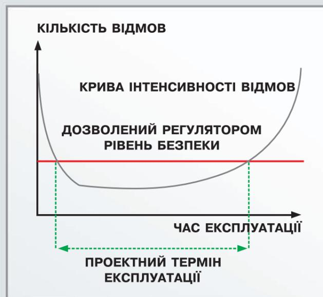
Рис.1 Залежність кількості відмов обладнання від терміну його експлуатації
